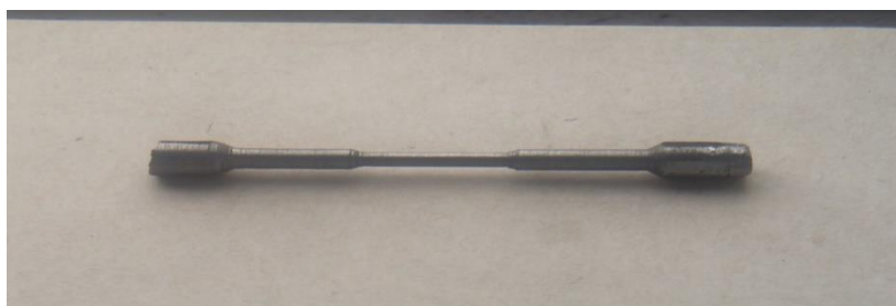
2 Сурет - Механикалық сынауға арналған 09Г2С болаттан жасалған үлгі
