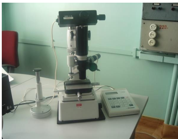
6 Сурет - Микроқаттылықты өлшейтін құрылғының жалпы түрі ПМТ-3М
