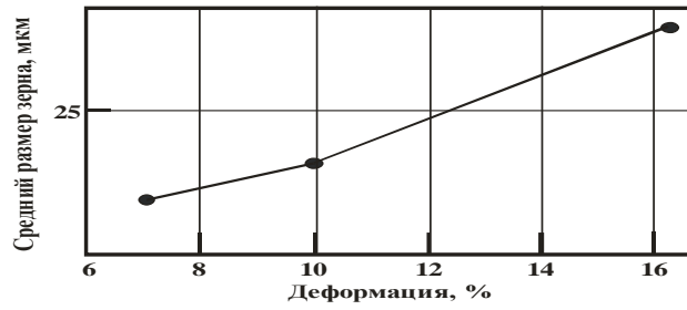
31 Сурет - 09Г2С болат дәнінің орташа мөлшерінің жасытқаннан кейін жинақталған пластикалық деформацияға тәуелділігі 625 °С температурада
